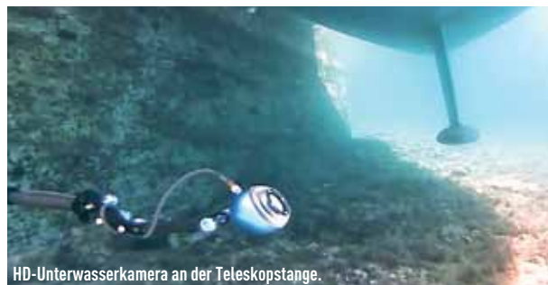
HD-Unterwasserkamera an der Teleskopstange.
